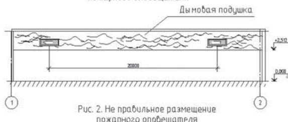
Рис. 2. Не правильное размещение пожарного оповещателя
